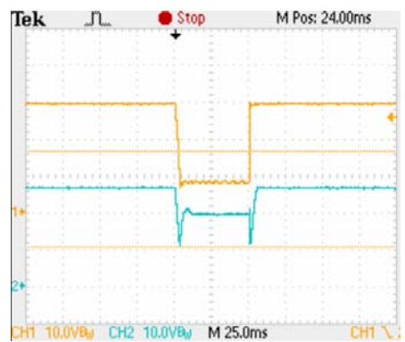
图6 8V/50ms (通道1:输入电压, 通道2输出电压)
