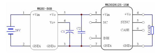
注: C1 外接保持电容 C2 渡越电容,50W输出功率参考值100µF。输入地与输出地内部已短接。
