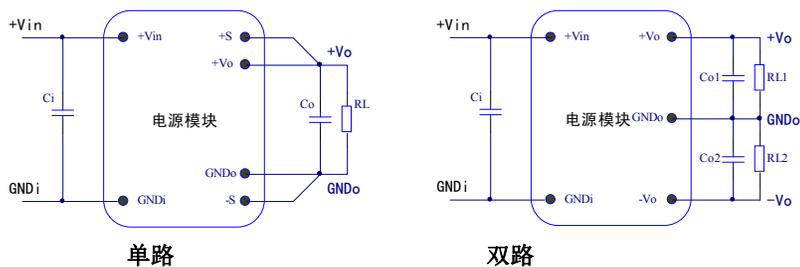
$C_i$  电容推荐使用低 ESR 的 10 $\mu$ F 左右的大容量电容。
