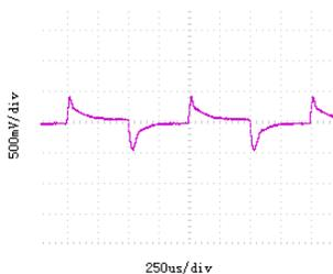
3: 输出纹波电压(20MHz)
