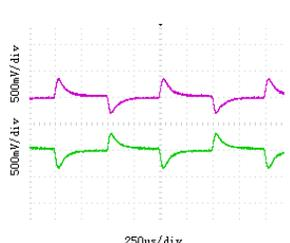
3: 输出纹波电压(20MHz)
